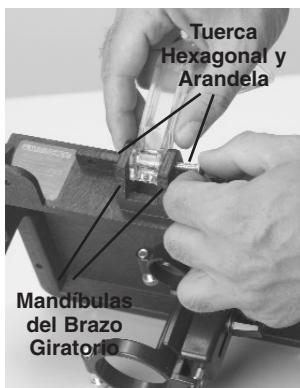
5. Inserte una de las dos Tuerca de Pernos de Coche (#36099) desde la parte inferior hacia arriba a través del hueco ranurado en la Mesa de Trabajo y en el orificio más cercano a la Cuña Angular en la Guía de la Mesa. Ajuste apenas con uno de las dos Tuercas Mariposa (#36100)
